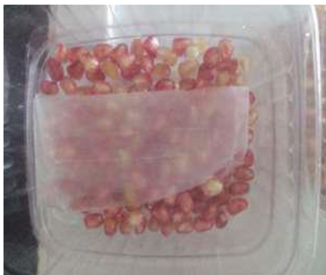
شکل 2- دانه‌های انار پس از شش روز نگهداری در بسته‌بندی فعال حاوی 2 درصد کارواکرول در دمای اتاق
