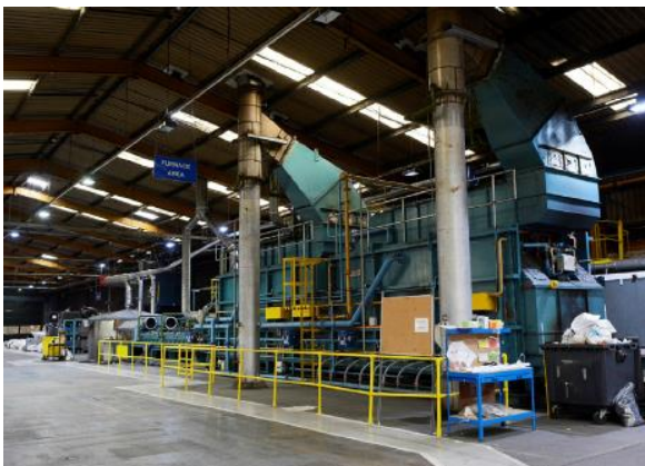
شکل ۸- کوره فرآیند پیرولیز مورد استفاده در شرکت ELG. [۲۵]
