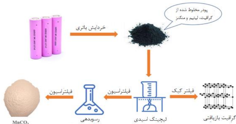
شکل ۳. فرآیند ارائه شده توسط چن چانگ و همکاران برای بازیافت باتری لیتیم منگنز اکسید [۱۴]
