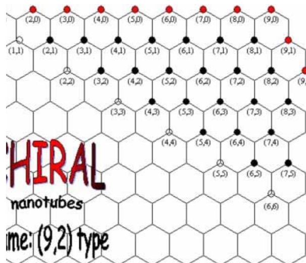
شکل (۴) پیچش کایرال گرافیت و نوع (۹,۲) نانولوله
